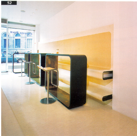
Über die Bistrobank und den Boden legt sich ein 3 mm dünnes, cremeweißes Vinyl, welches sich an den Stirnseiten als „Coating“ abzeichnet
